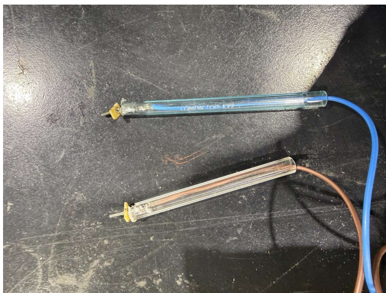
Figura 1 — Pontas de prova prontas: terminais soldados e isolados em tubos plásticos
