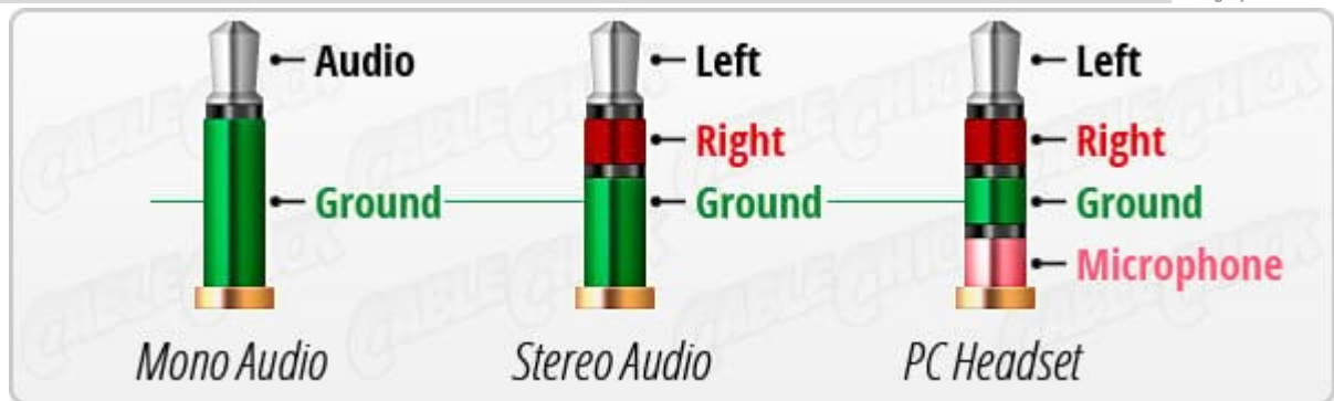
Figura 2: Diagrama de ligação cabo P2 (datasheet)
