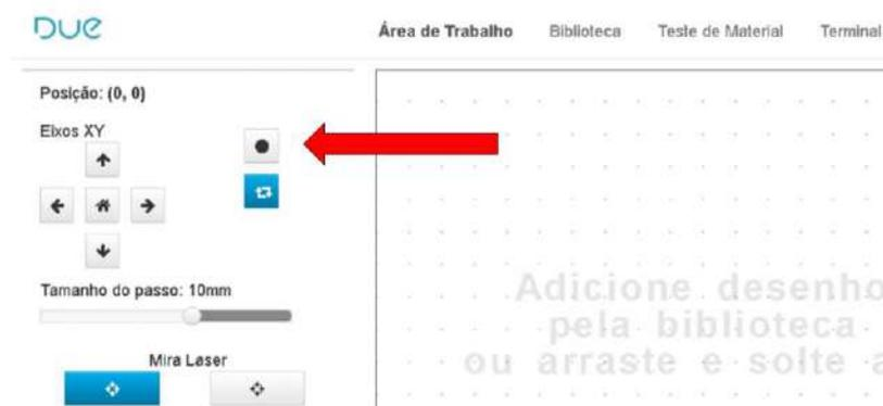
Ele torna a posição atual do canhão laser para a máquina igual a  $x=0$  e  $y=0$  no software.
