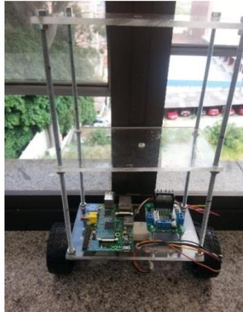
Figura 2. Sistema a ser controlado.
